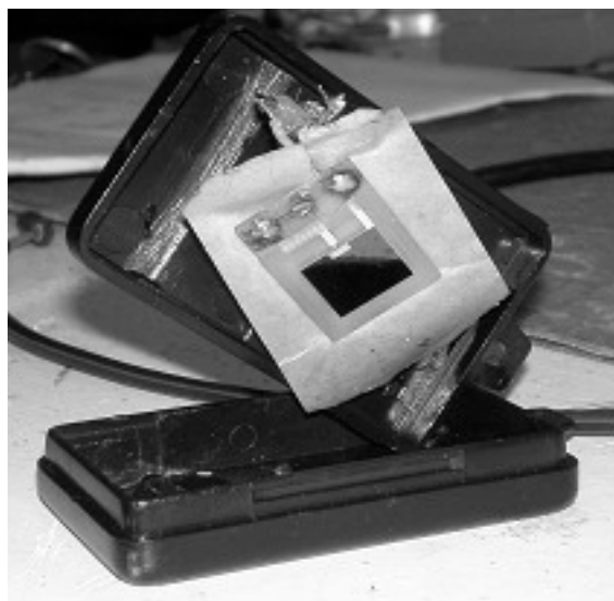
Figura 3 - Diodo fotovoltaico inserido em uma cápsula para bloqueio de luz visível Fonte: Os autores (2012).
